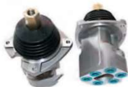
卡特320D操纵杆总成 E320D/E330D/E336D 2970589 PILOT VALVE
