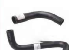
上水管/下水管 SK100-1/SK120-1
