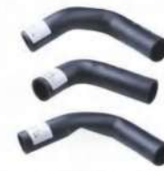
上水管/中水管/下水管 HD700-2 HD800-5/7 HD900-5/7
