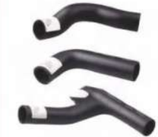
上水管/中水管 下水管 CAT320
