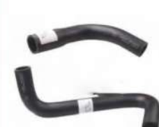
上水管/下水管 SK100-1/SK120-1
